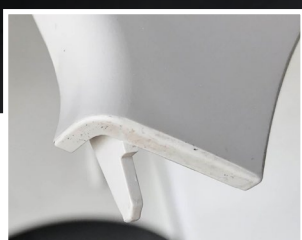
AVANT NETTOYAGE : Contamination des pièces par les résidus du moule
